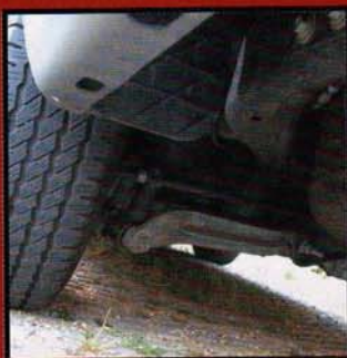
Solide châssis et roues indépendantes à l'arrière, visiblement Lincoln a mis le doigt sur un excellent compromis. Encore une fois la suspension pneumatique joue un rôle capital dans la quasi parfaite tenue de route du Navigator.
