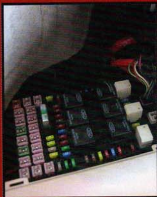
La boîte à fusible située aux pieds du passager s'avère complète et ne cache pas ses origines Ford.
